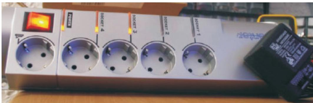
Bild 7.15: Zwei Steckdosen (die linke und die ganz rechte, hier mit Steckernetzteil) sind immer an
