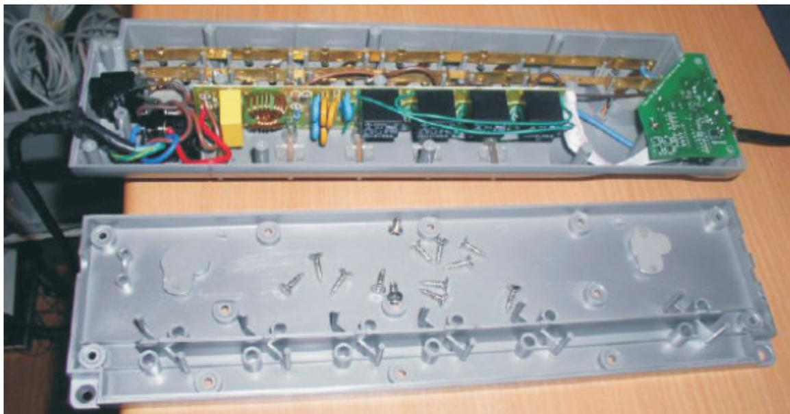
Bild 7.3: Die Bodenplatte wird abgeschraubt.
