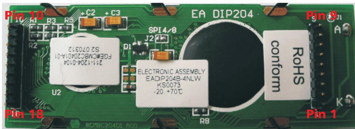
Bild 1.6: Pin-Reihenfolge beim Display.
