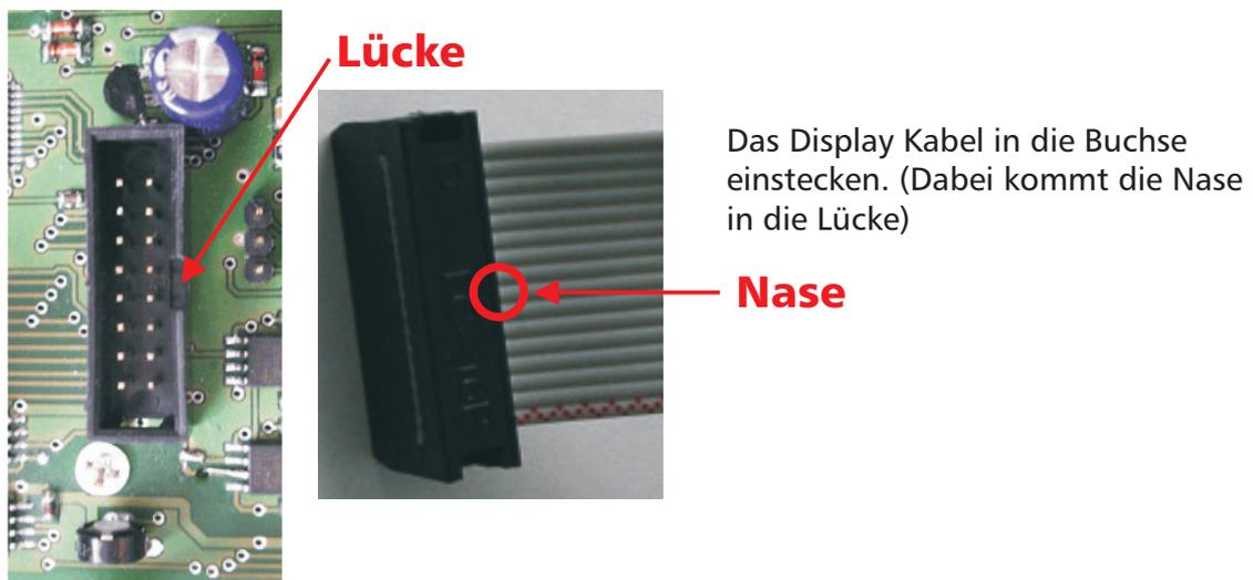
Bild 1.10 und 1.11: Anschluss des Display-Kabels an die Platine..
