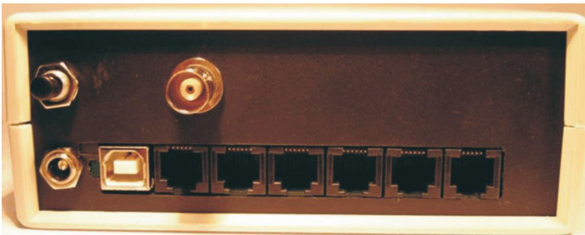
Bild 1.19: Der fertige AquaPIC von hinten.
